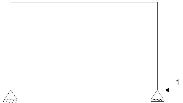
Figura 4 – Pórtico isostático com carga horizontal.
