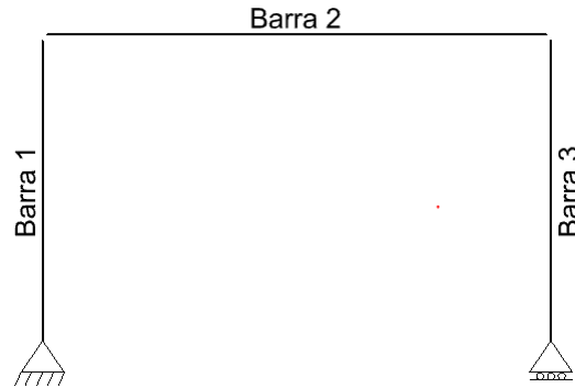
Figura 5 – Divisão da estrutura em barras.
