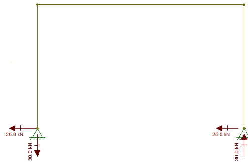
Figura 15 – Reações de apoio.
